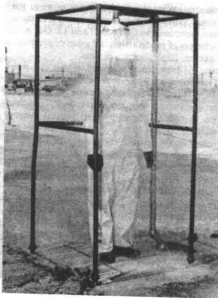
图 20-4 操作人员在处理危险性或腐蚀性液体推进剂时使用的塑料安全服、手套、靴子和帽子。当人站在平台上后，安全淋浴器就会自动打开，洗掉溅上或滴上的推进剂（美国空军官方照片）
