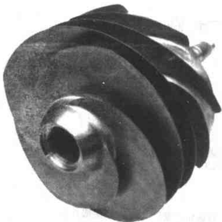
图 10-8 航天飞机主发动机低压燃料涡轮泵的诱导轮叶轮。其直径约 10in, 氢额定流量 148.6 lb/s, 抽吸压力 30 psi, 在 15765rpm 下出口压力为 280 psi, 效率为 0.77, 当用水试验时抽吸比转速为 39000 (波音公司 Rocketdyne Propulsion and Power 提供)
