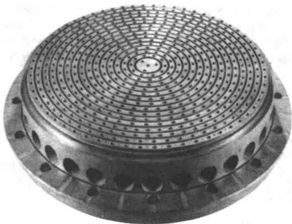
图 8-4 90°双股自击式（燃料对燃料、氧化剂对氧化剂）埋头孔喷注器。大孔是燃料集液腔进口。预先钻孔的喷注器环交替钎焊在一环形燃料集液腔（或沟槽）和一类似的相邻的氧化剂集液腔（或沟槽）上。图 8-1 画出了一类似但较大的喷注器的截面
