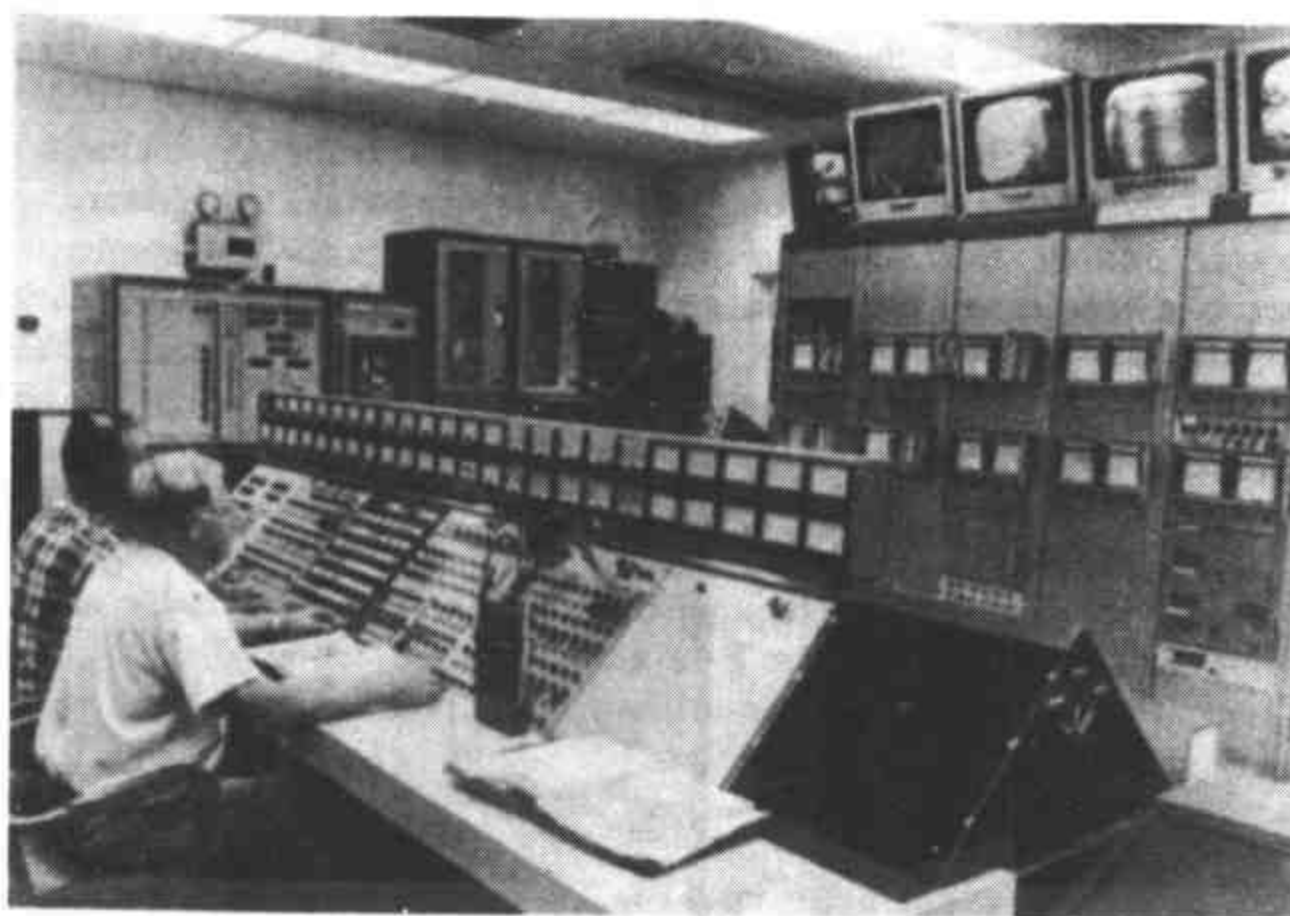
图 20-3 用于试验操作人员工作、放置记录仪器和实施控制的控制室（在加强的混凝土掩体内）。 内有控制台、闭路电视、无线及有线电话、直接显示仪表、条形图显示器、高速磁带记录器、示 波器、空气品质监测报警器和应急灯（美国空军 Phillips 实验室提供）
